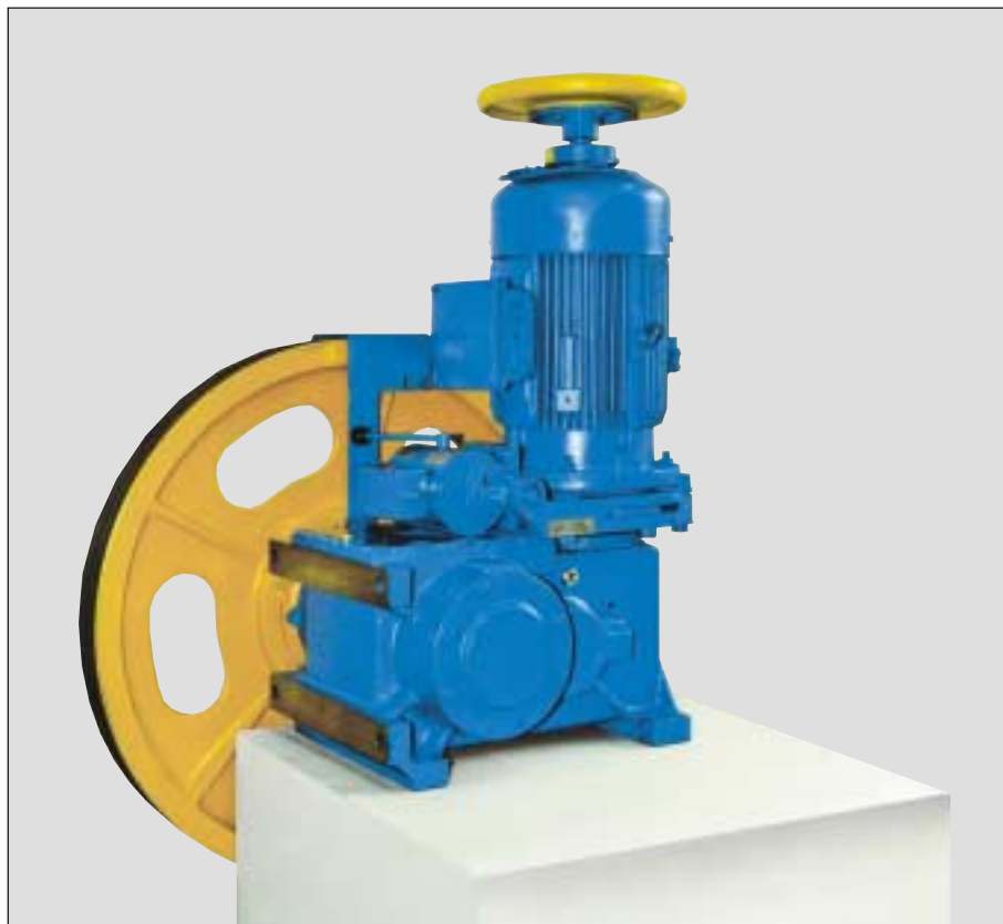
Abb. 3: Flender-Aufzugsantrieb für Nutzlast Q = 1500 kg und Fahrgeschwindigkeit 1,2 m/s. Seilauflhängung 2:1 und Gegengewichtsausgleich 50 %
